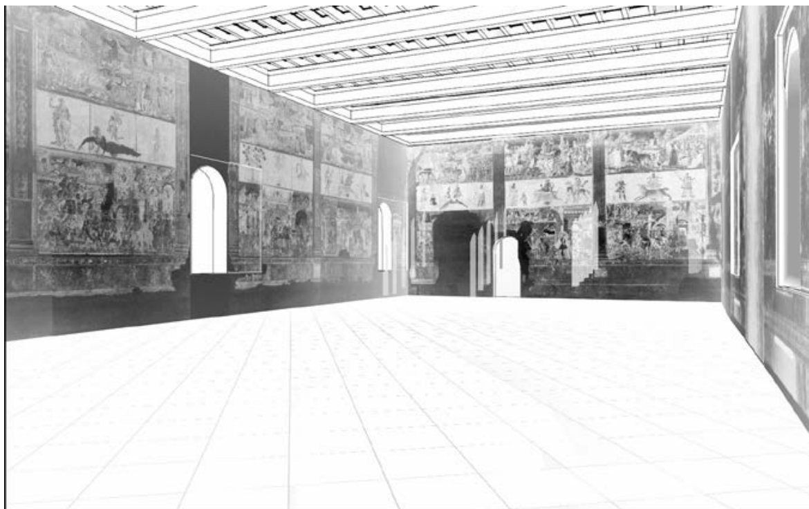
FIG. 11.3. Attraverso il modello 3D è stato verificato il percorso delle macchie di luce naturale sugli affreschi. L'immagine mostra gli ultimi istanti al tramonto del Sole nel giorno del 1 ottobre del secolo XV: in tale data alcune immagini del duca Borso vengono più volte illuminate da fasci di luce
